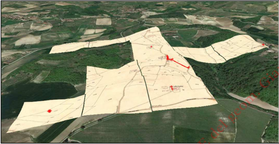
Figura 85 – L'esempio di georeferenziazione Parametrica esportato su Google Earth.
